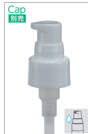
② φ24ボトル用 Z-500ワンドロップポンプ ホワイト Z-500-C014-1-100×129R WH 露出長129mm ローレット無 吐出量約0.5mL
